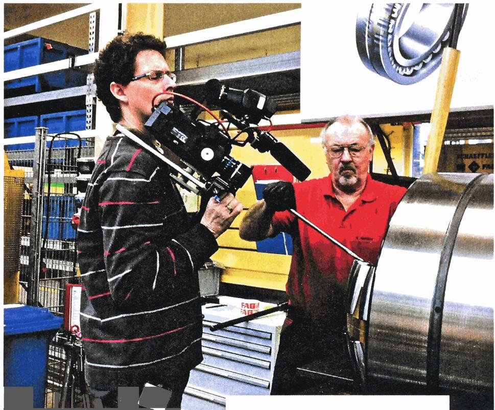
↑ Im Bereich der Großlagerfertigung war die Endmontage der Pendelrollenlager von besonderem Interesse. Im Bild: Kameramann Stefan Moser schaut Gerhard Nicklaus beim Einsetzen der Tonnenrollen über die Schulter. Eine einzelne Tonnenrolle wiegt rund zehn Kilogramm.
